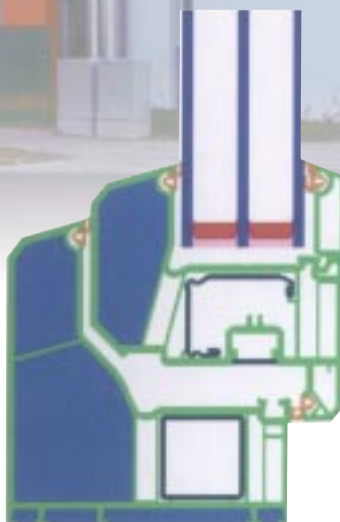
Isothermenkarte mit Wärmestromlinien für Blendrahmen und Flügelrahmen.
